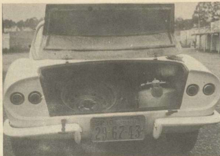
Detalhe da instalação do tanque auxiliar para medição do consumo de combustível
